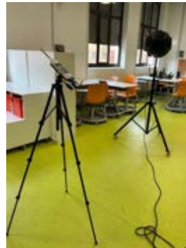
Algunas imágenes tomadas en el día del ensayo de aislamiento a ruido aéreo entre dos espacios
