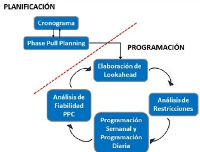
Figura 1: LPS y sus elementos (Adaptado de [1]).
